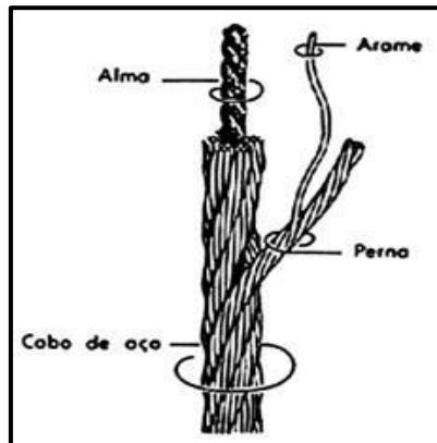
• **Medição do diâmetro:** o diâmetro do cabo de aço é aquele da sua circunferência máxima.
