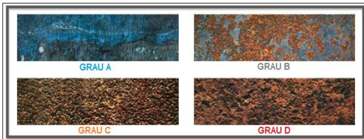
**Grau A** – Superfície de aço com a carepa de laminação praticamente intacta em toda a superfície e sem corrosão. Representa a superfície de aço recentemente laminada, (**limpeza periódica**).
