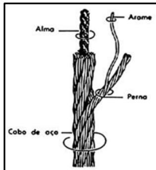
• **Medição do diâmetro:** o diâmetro do cabo de aço é aquele da sua circunferência máxima.
